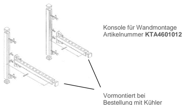
Bestellbeispiel : **BCR05-2420-2-00-F** → Messgas-Kompressorkühler **BCR05 Ex** mit 2 Dual-Wärmetauschern aus Edelstahl, im Wandmontage-Gehäuse mit vormontierter Konsole und mit einer Spannung von 230V 50/60Hz
